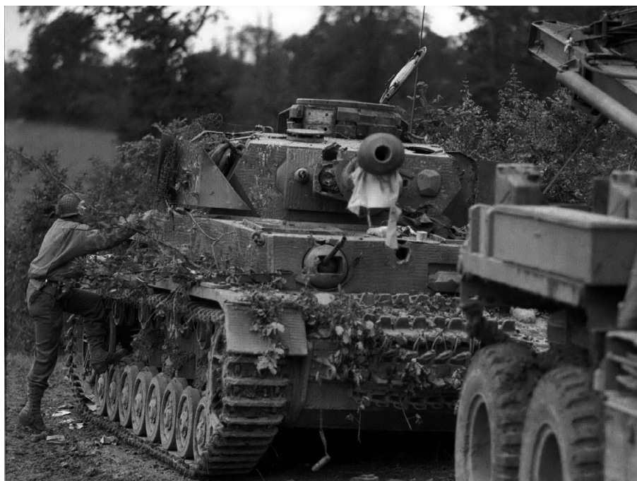
Американцы эвакуируют подбитый немецкий танк Pz.Kpfw. IV. Сквозную пробойну в Pz.Kpfw. IV.Ausf.J из 6-ой роты 2-го танкового полка СС сделали бойцы 117-го пехотного полка 80-й пехотной дивизии Армии США. На переднем плане эвакуатор M1A1. Франция, июль 1944 г.
